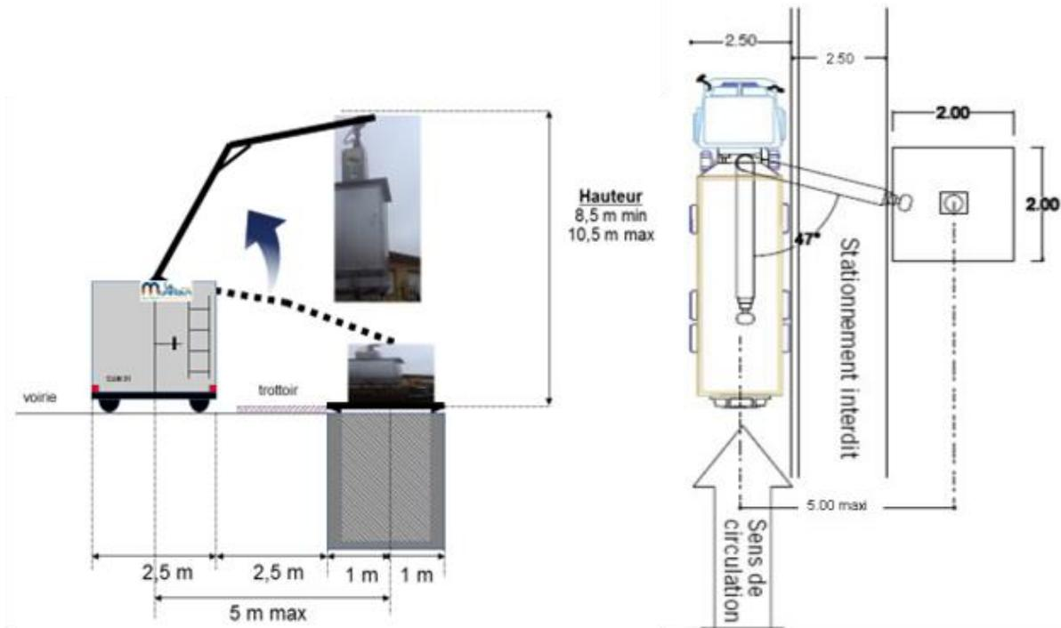
De plus, il est important que le temps de la collecte, le véhicule d'exploitation ne soit pas en situation dangereuse sur la voirie. Aucun élément aérien ne doit entraver la collecte en grue : candélabre, réseau électrique aérien,...
